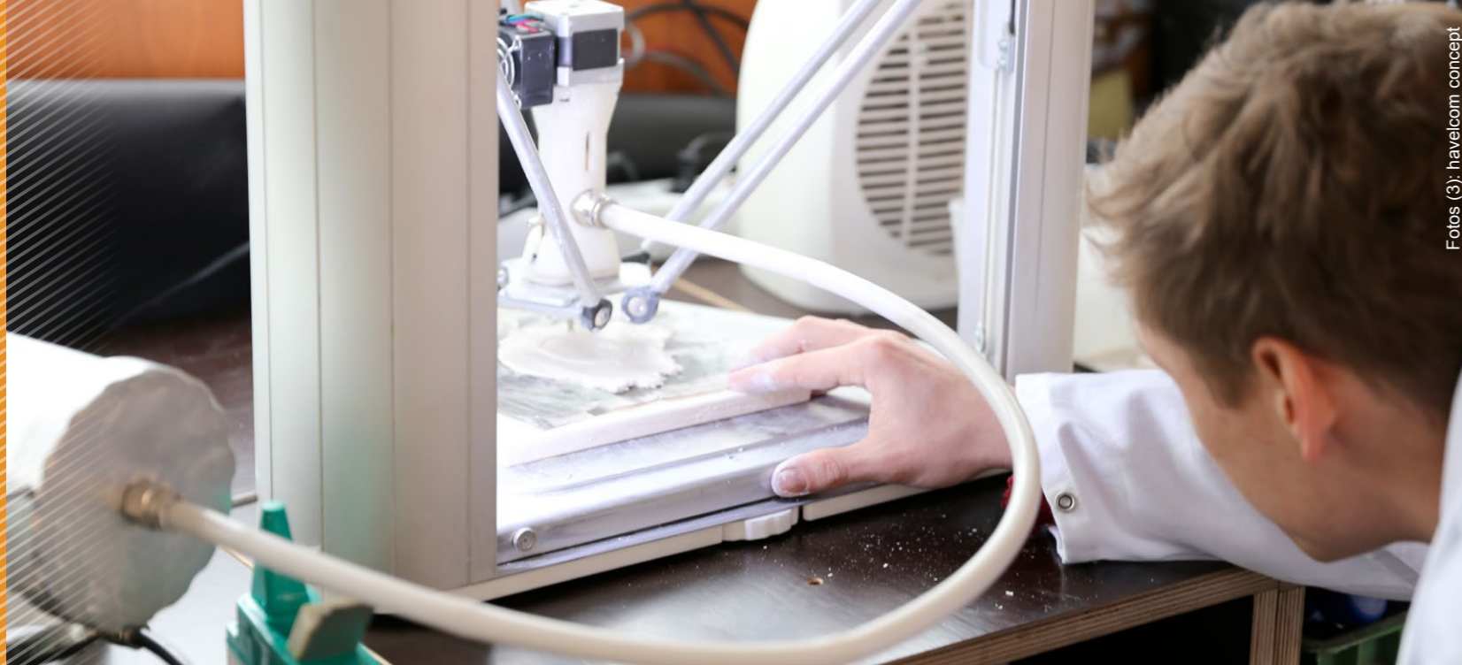
Im 3D-Drucker können auch Objekte aus Keramik entstehen, die wie beim herkömmlichen Verfahren mit Kunststoff Schicht für Schicht aufgebaut werden.
